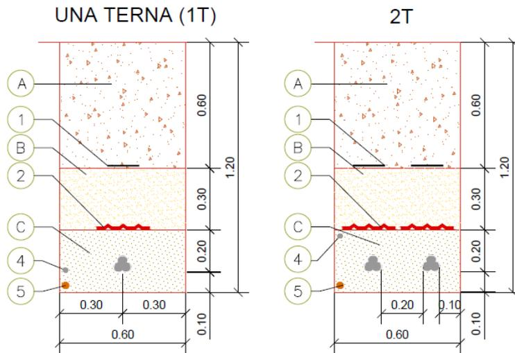
Detalle Sección Zanja. Tipo conductor directamente enterrado. (Lateral vial o por tierras)
