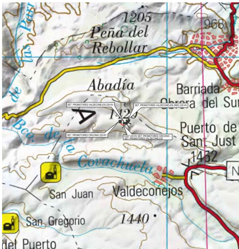
Las cotas del terreno en el trazado de la línea varían aproximadamente entre 1.340 m sobre el nivel del mar al principio de la línea y los 1.365 m al final de la misma. Por tanto, según el vigente Reglamento de Líneas de Alta Tensión, se deberá considerar a efectos de cálculo la Zona C
