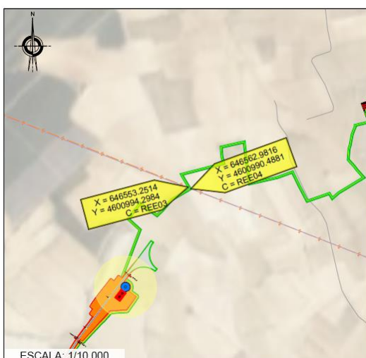
Imagen 23: Vista en detalle de los cruces de línea aérea de alta tensión (220 kV) con la línea de evacuación de media tensión subterránea del parque eólico IRIDIO (2)
