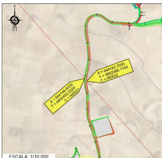
Imagen 22: Vista en detalle de los cruces de línea aérea de alta tensión (220 kV) con la línea de evacuación de media tensión subterránea del parque eólico IRIDIO (1)
