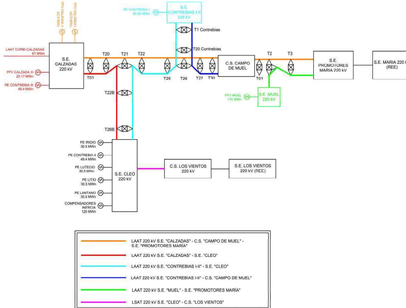
Con motivo del cambio del punto de conexión a la red de transporte de los Parques Eólicos “Contrebia I” y “Contrebia II”, se redacta el Proyecto Modificado de la Línea Aérea de Alta Tensión 220 kV S.E. “Contrebias I-II” – C. S. “Campo de Muel”. El nuevo punto de conexión de las instalaciones se plantea en el nudo “Los Vientos” 220 kV (Red Eléctrica).
