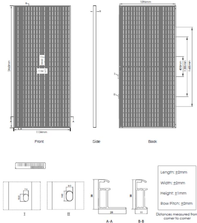
Figura 8: Dimensiones del Módulo
