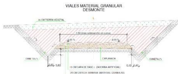
Figura 3. Accesos y viales internos. Viales primarios
