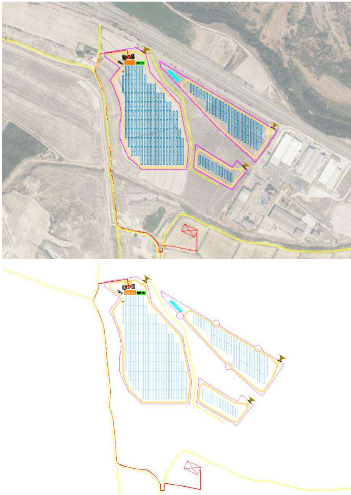
Figura 6: Layout de la Planta Solar FV
