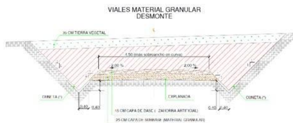
Figura 3. Accesos y viales internos. Viales primarios
