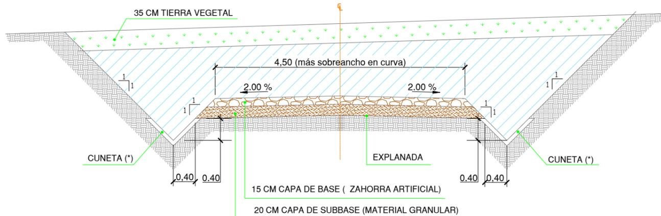
**Viales:** Son aquellos viales existentes, acondicionados o de nueva construcción, que permiten el movimiento y transporte de la maquinaria de construcción y transporte de equipos y grúas necesarios para el montaje del parque y para su explotación. En el diseño se tendrá en cuenta los requerimientos de la Especificación Técnica del fabricante
