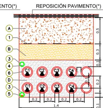
ZANJAS 18/30 KV CONDUCTOR ENTUBADO: BAJO CALZADA O ACERA EN ZONA URBANA
