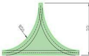
Las áreas de giro deberán tener forma de trompeta, con radios de giro de 25 metros a ambos lados, así como una profundidad total de 40 m en línea recta.
