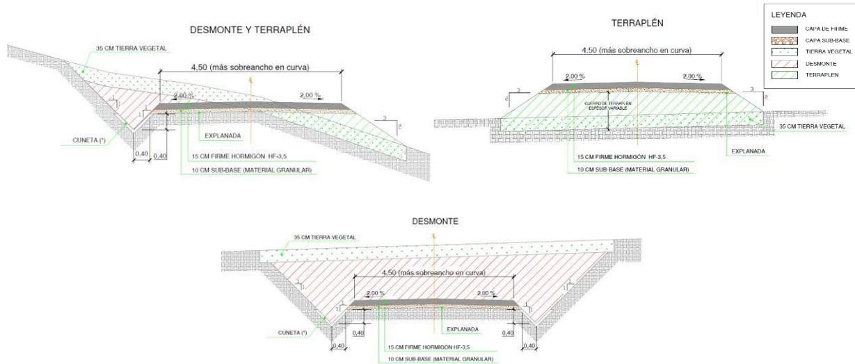
**Figura 6. Accesos y viales internos. Viales hormigonados**
