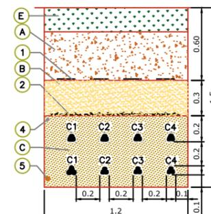
ZANJAS 18/30 KV CONDUCTOR ENTUBADO: BAJO VIALES/CAMINOS O DRENAJES
