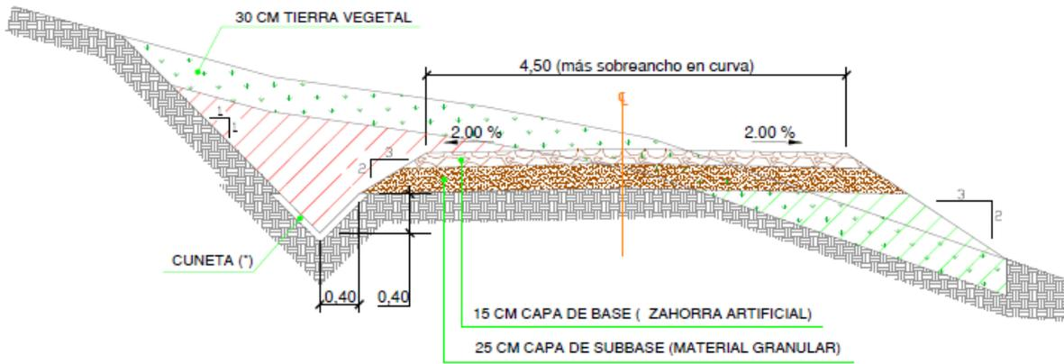
*Sección tipo granular a emplear en viales interiores del parque*
