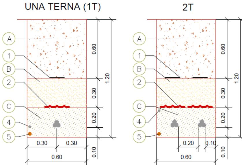
*Detalle Sección Zanja. Tipo conductor directamente enterrado. (Lateral vial o por tierras) (1 de 2)*
