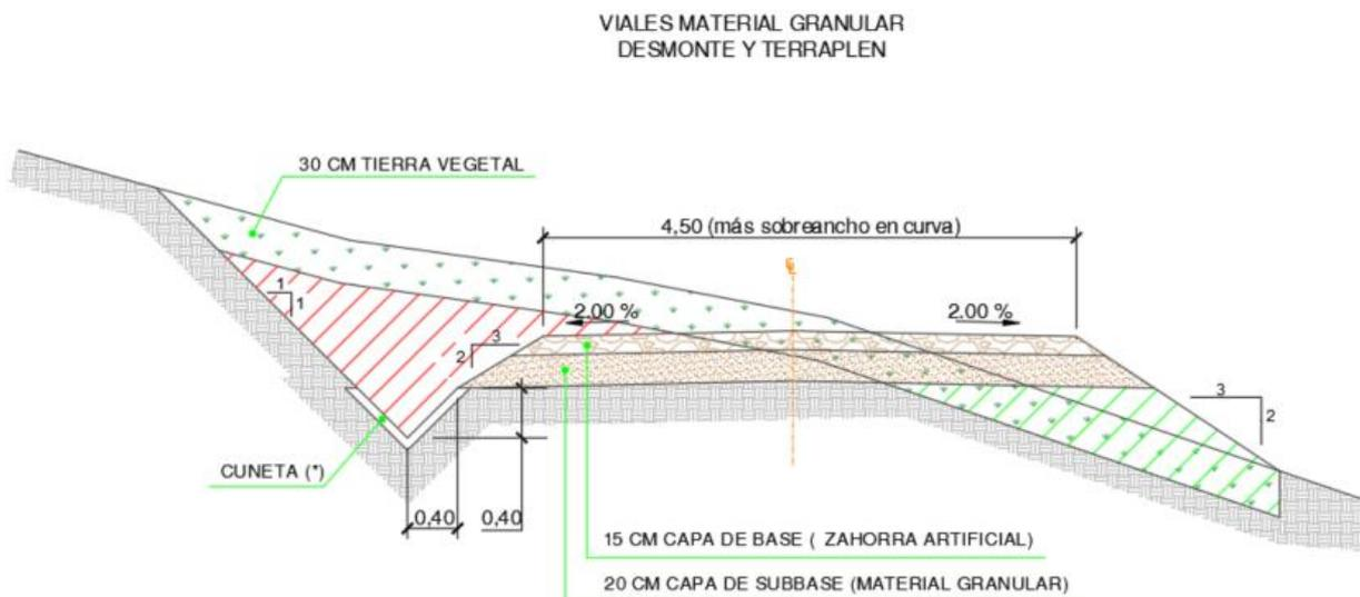
Imagen 3: Sección tipo material granular
