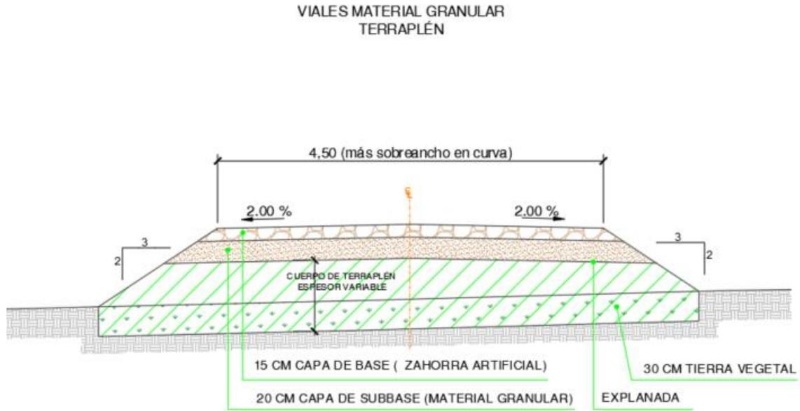
Imagen 4: Sección tipo granular en terraplén
