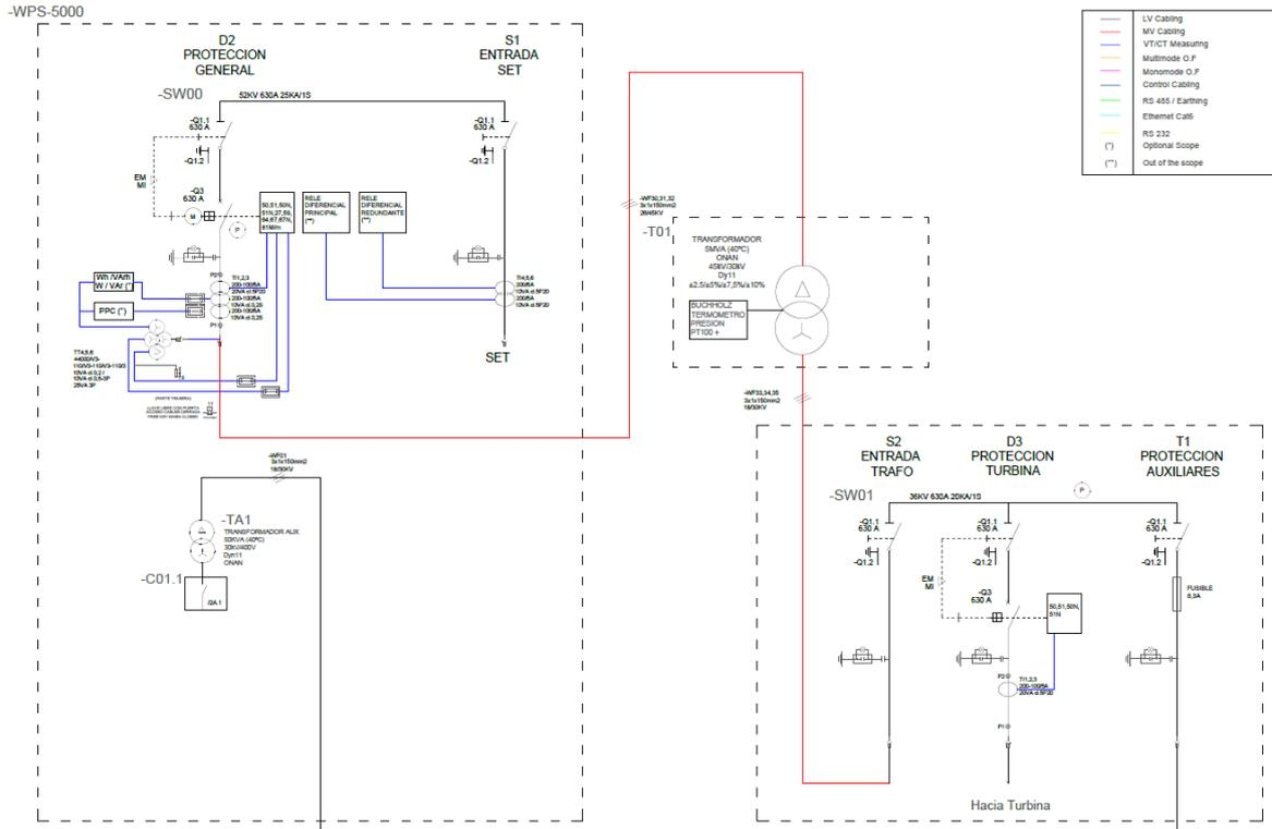
Imagen 2: esquema de conexión a instalación existente
