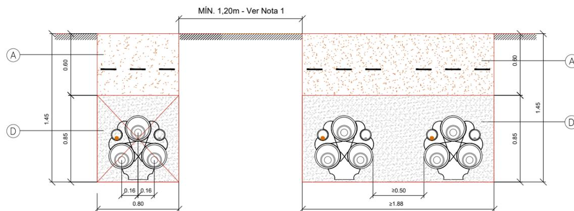
HORMIGONADA ENTUBADA NUEVA CONSTRUCCIÓN
