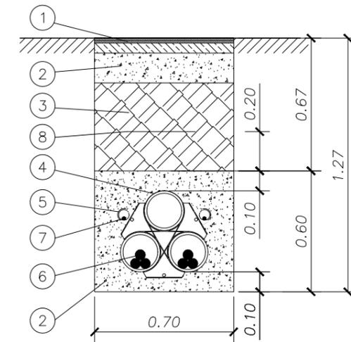
ZANJA PARA DOS CIRCUITOS MEDIA TENSION EN CRUCE DE CAMINO SIN ASFALTAR (1 TUBO Ø200 DE RESERVA)
