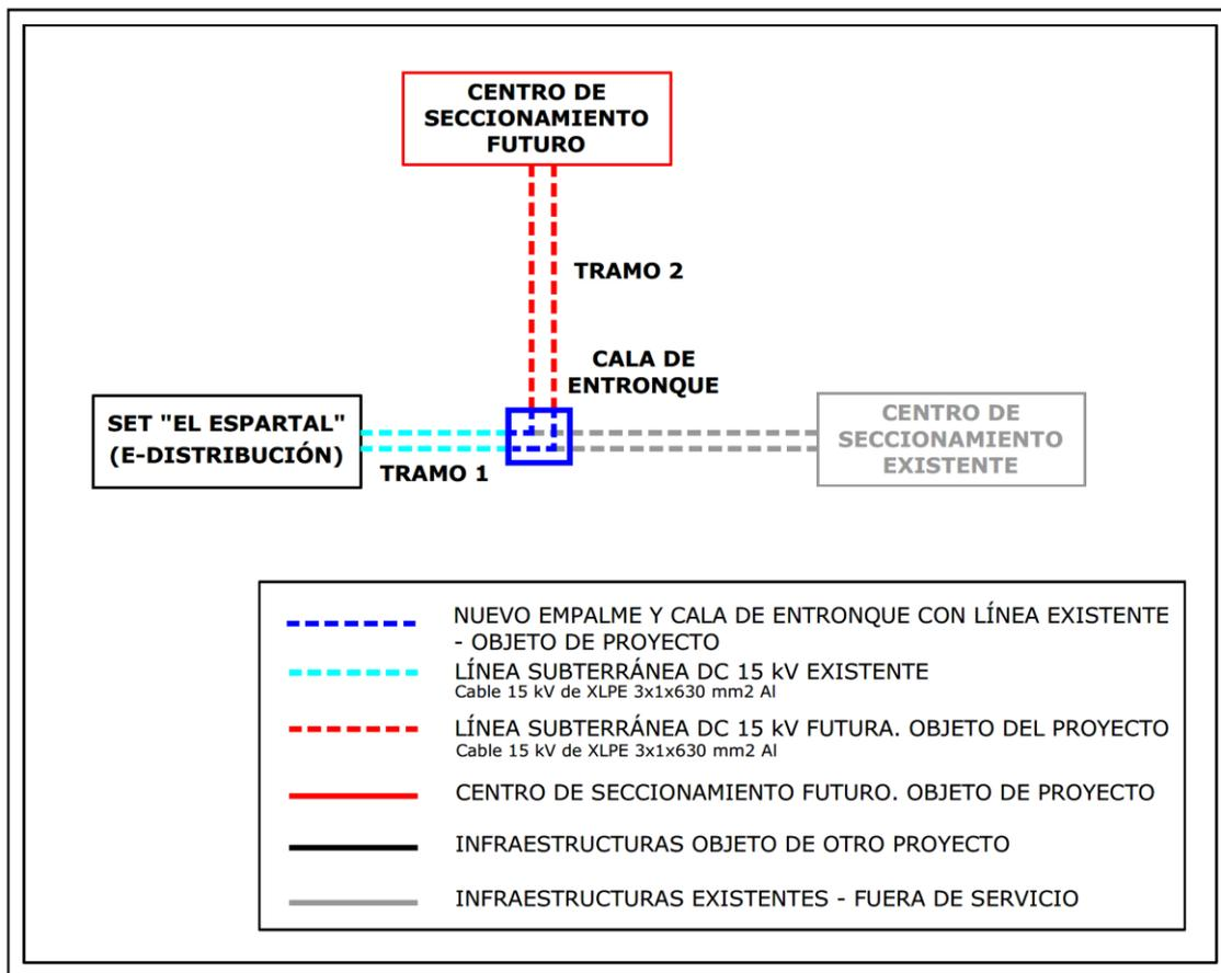
Tal y como puede observarse en la imagen, desde el origen en la Subestación "El Espartal" hasta su llegada al nuevo Centro de Seccionamiento a proyectar, la línea puede dividirse en dos tramos, separados entre ellos por el empalme a realizar en la cala de entronque a ejecutar.
