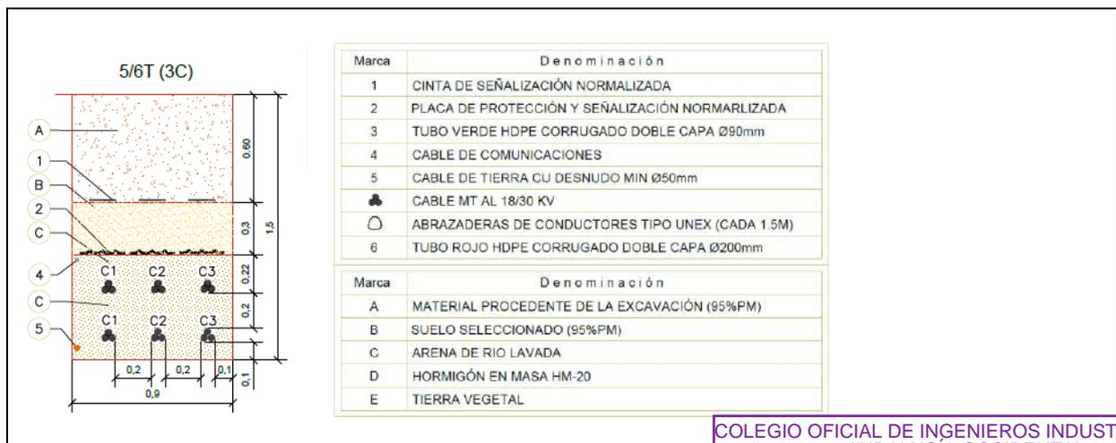
Ilustración 17 Detalle Sección Zanjas Tipo 5/6T. Conductor enterrado
