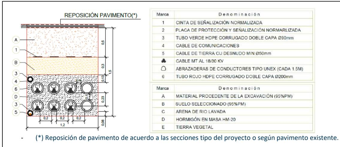
Ilustración 18 Detalle Sección Zanjas Tipo 5/6T\*. Conductor bajo vial
