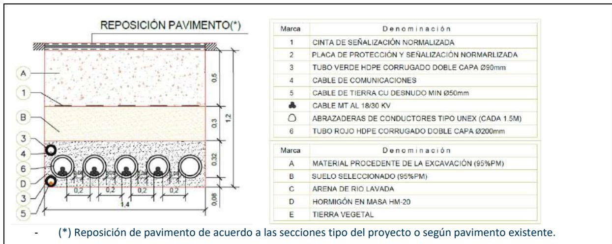
Ilustración 16 Detalle Sección Zanjas Tipo 4T\*. Conductor bajo vial
