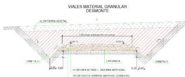
Figura 3. Accesos y viales internos. Viales primarios
