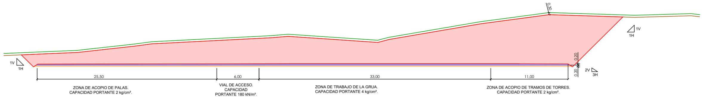
SECCIÓN TIPO PLATAFORMA EN TERRAPLÉN. ESCALA 1:300
