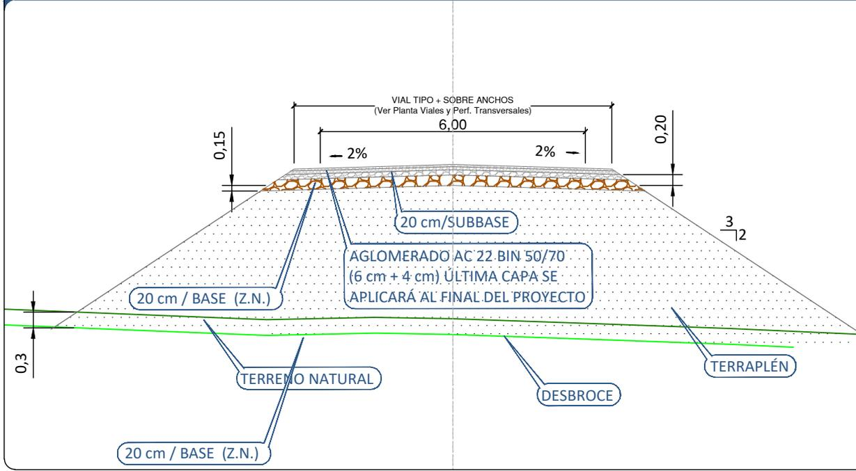
SECCIÓN TIPO VIAL ASFALTADO (ENTRONQUES) + SOBRE ANCHOS (EN DESMONTE)
