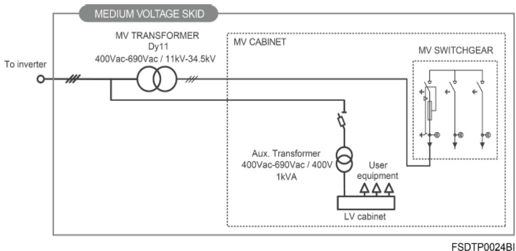
**Figura 5.** Diagrama operacional Freesun MV SKID Frame 2.
