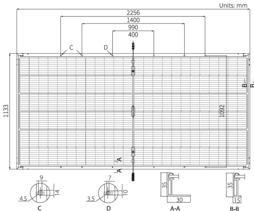
**Figura 2.** Diseño del módulo LONGI, modelo bifacial LR5-72HBD de 540 Wp
