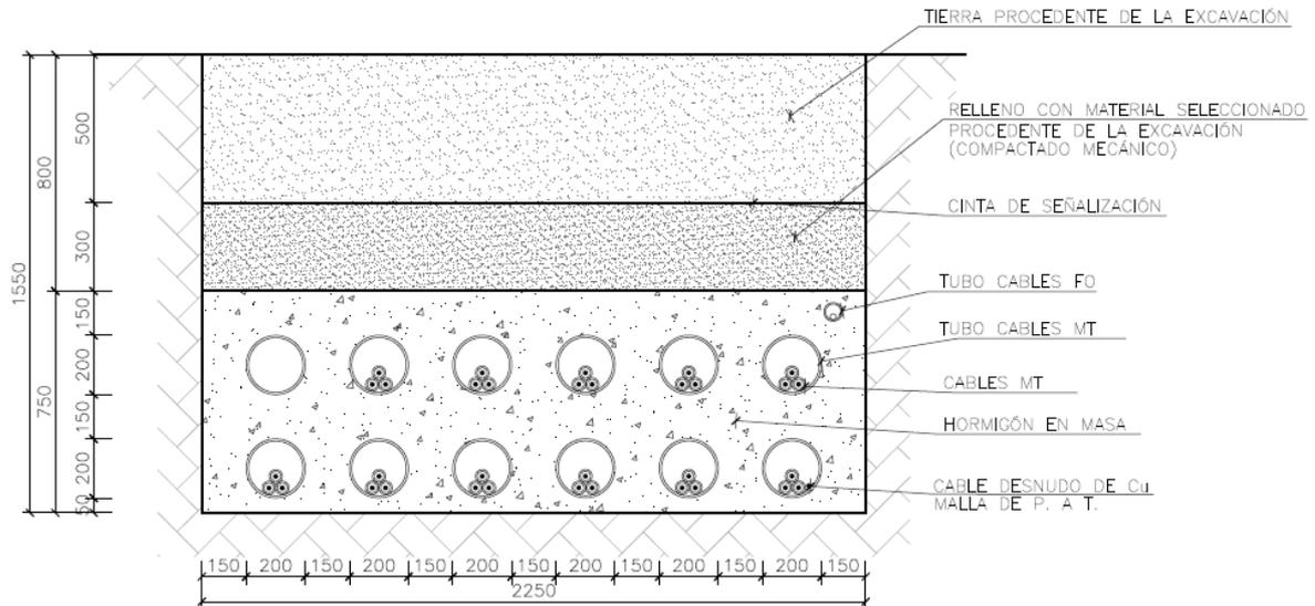
**Figura 6.** Zanja tipo MT 11 Circuitos (Tramo 3)
