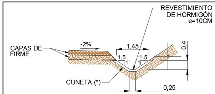
Figura 13. Croquis cuneta trapezoidal revestida profundidad 40 cm
