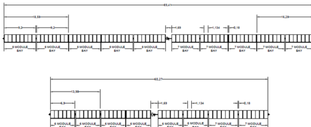
Figura 3. Planos del seguidor NEXTRACKER, modelo NX HORIZON
