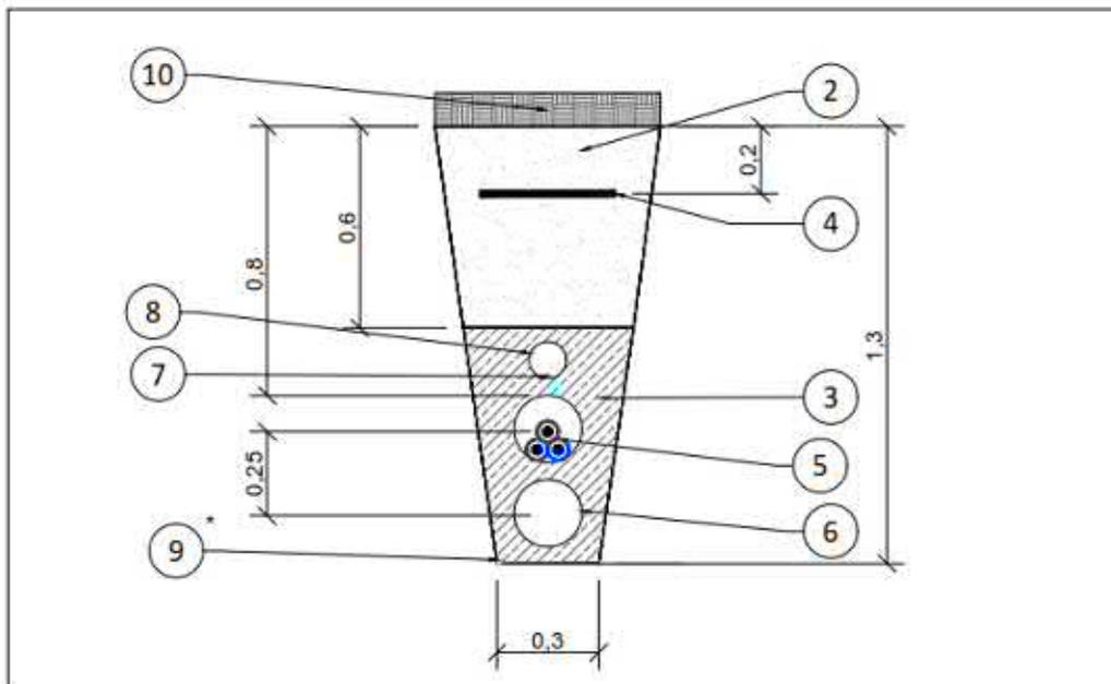
Figura 5: Colocación de cables en tresbolillo.
