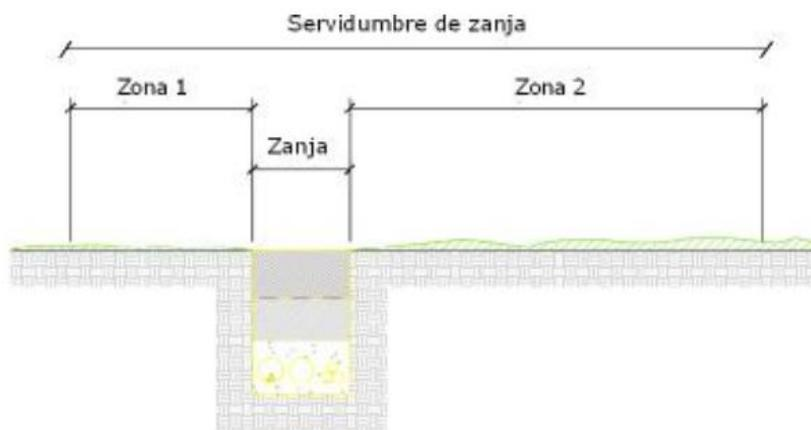
Figura: Sección Transversal de detalle de servidumbre de zanja
