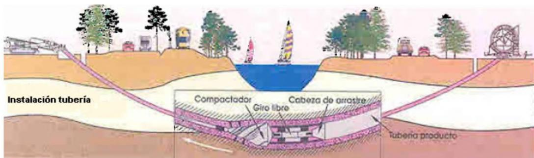
Para los cruces proyectados, la perforación horizontal dirigida será de 800 mm de diámetro, en la que se introducirá una vaina de polietileno del mismo diámetro. La arista superior del tubo protector estará a un máximo de 6 m del firme en el punto medio.
