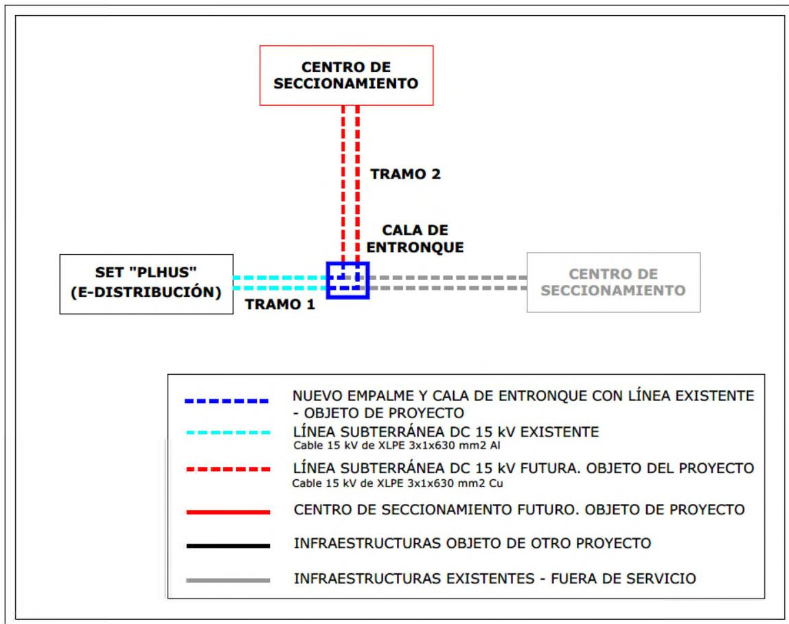
Tal y como puede observarse en la imagen, desde el origen en la Subestación “PIhus” hasta su llegada al nuevo Centro de Seccionamiento a proyectar, la línea puede dividirse en dos tramos, separados entre ellos por el empalme a realizar en la cala de entronque a ejecutar.
