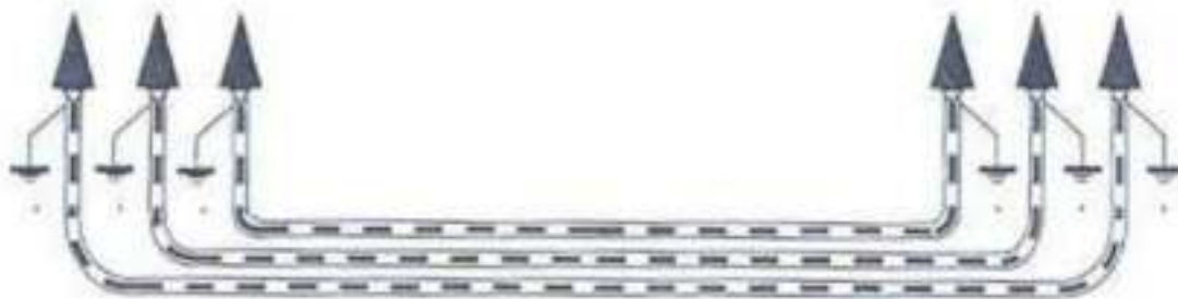
Figura 18: Puesta a tierra de cubiertas metálicas.
