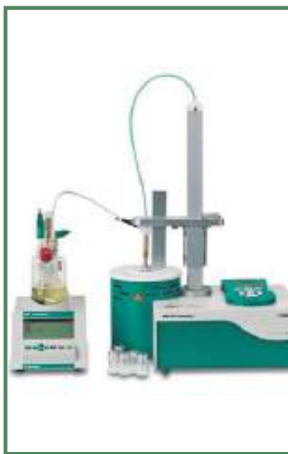
Análisis para la determinación humedad líquido dieléctrico
