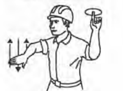
10. BAJAR EL AGUJÓN Y LEVANTAR LA CARGA
