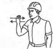
12. AVANZAR EN LA DIRECCIÓN INDICADA POR EL SEÑALISTA
