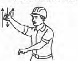
5. LEVANTAR EL AGUJÓN O PLUMA Y BAJAR LA CARGA
