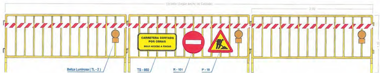
SEÑALIZACIÓN DE CORTE PROVISIONAL DE CARRETERA e - 1 / 10
