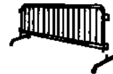
BARRERAS DE DESVIO DEL TRÁFICO
