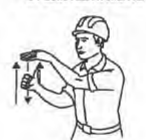
4. LEVANTAR EL AGUJÓN O PLUMA LENTAMENTE
