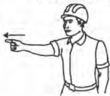
11. GIRAR EL AGUJÓN EN LA DIRECCIÓN INDICADA POR EL DEDO
