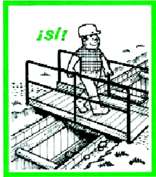
Se deben instalar pasarelas provistas de barandillas para franquear las zanjas.
