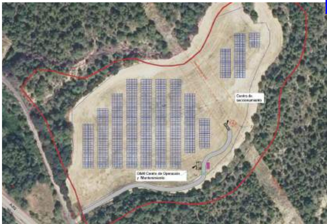
Imagen 3: Distribución de los módulos fotovoltaicos.
