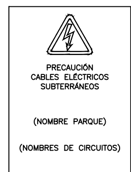
DETALLE X PLACA SEÑALIZACIÓN DE PELIGRO
