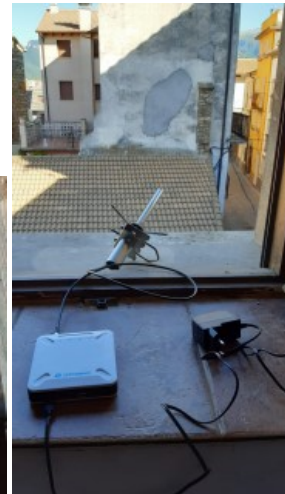
Primera instalación de la antena en el casco urbano. Dio problemas de cobertura respecto a la zona de campo de experimentación.
