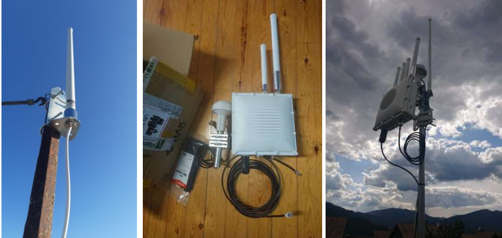
Cambio de modelo de antena para conseguir mejor recepción. Modelo inicial a la izquierda, modelo nuevo centro y a la derecha
