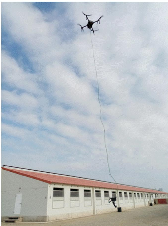
Foto 1. Dron con equipo de medida suspendido 5 metros.
