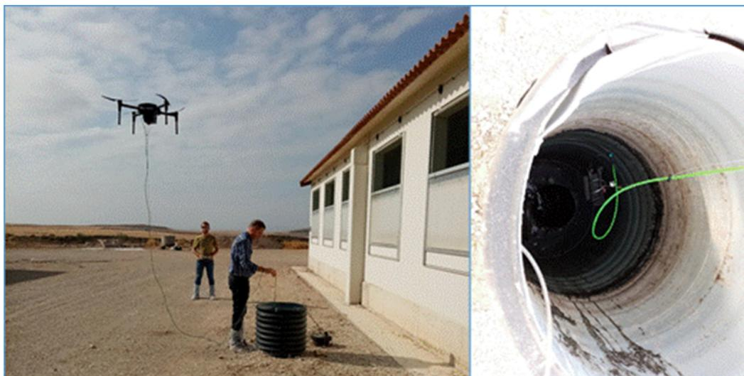
Foto 2. Ensayo de campo con Dron en arqueta pequeña.
