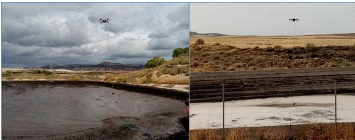
Foto 4. Vuelos del dron con la nueva configuración del sistema de medición sobre balsas de purín.
