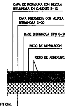
DETALLE PAVIMENTACION CARRETERAS AFECTADAS E=1/25
