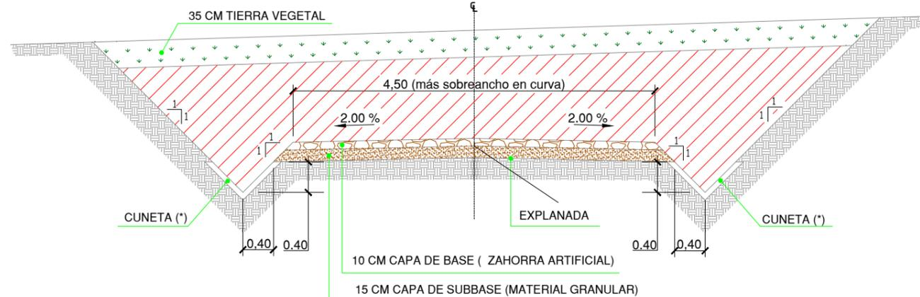
**Viales:** Son aquellos viales existentes, acondicionados o de nueva construcción, que permiten el movimiento y transporte de la maquinaria de construcción y transporte de equipos y grúas necesarios para el montaje del parque y para su explotación.
