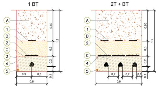
ZANJAS 18/30 KV CONDUCTOR ENTUBADO: BAJO CALZADA O ACERA EN ZONA URBANA
