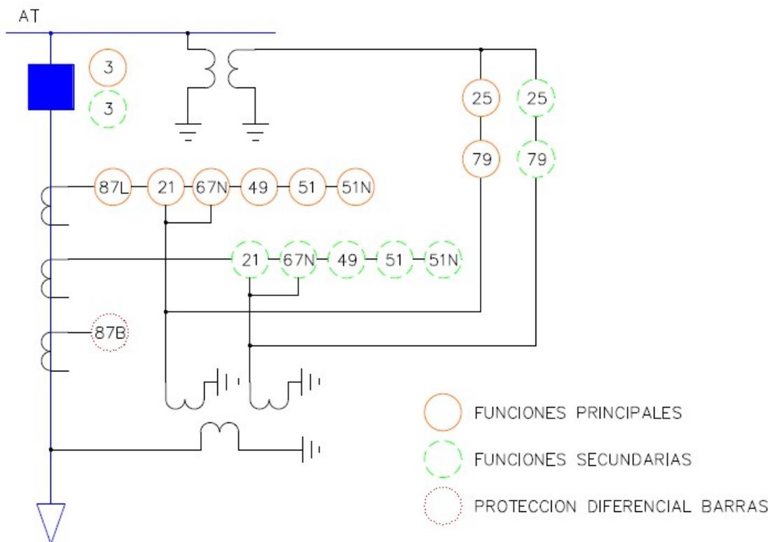
**NOTA:** La conexión por fibra óptica para la protección diferencial 87L no se contempla en el proyecto dado que las protecciones diferenciales asociadas actualmente no la precisan, debiendo instalarse los relés de protección correspondiente tanto en la SET de EDE como del productor. Se aplicará en su lugar la protección 21 de distancia.
