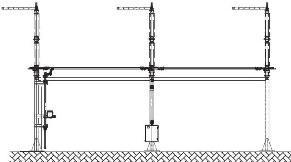
**10.4.3 CORTACIRCUITO FUSIBLE PARA PROTECCIÓN DE LOS TRAFOS DE TENSIÓN DE PROTECCIONES**
