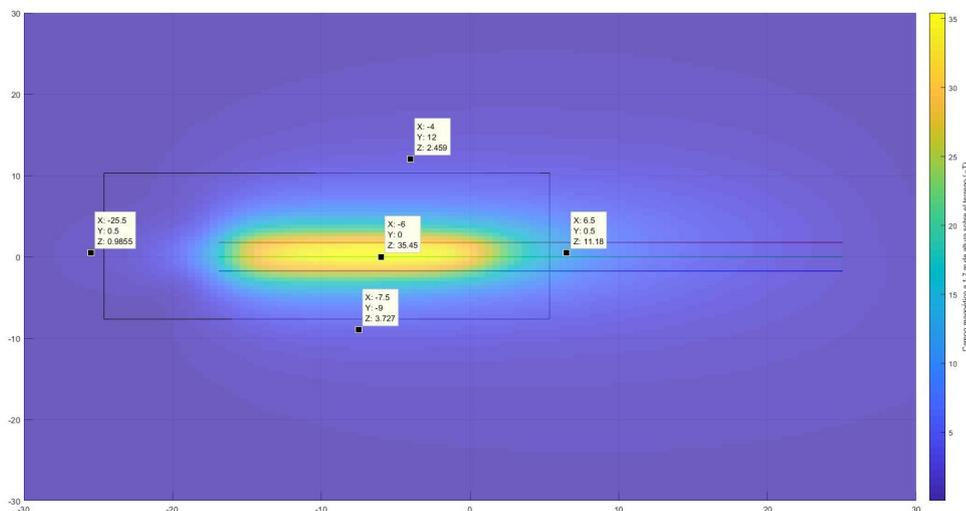
Figura 3: Representación del campo en planta en coordenadas X,Y, se observa que el máximo valor se da en el centro del embarrado y que a 1m del recinto de la SET, el valor máximo sería bajo línea de 11,18  $\mu\text{T}$  .
