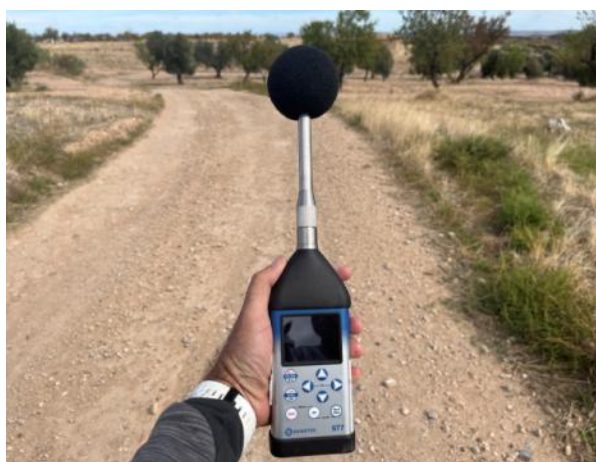
Figura 30: Sonómetro integrador modelo CESVA SC310 utilizado para la evaluación de los niveles de presión sonora en el parque eólico “Multitecnología”.
