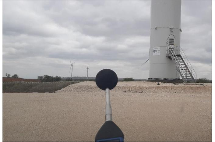
Fig. 2 Medición acústica en L6B.03. Fuente: Elaboración propia
