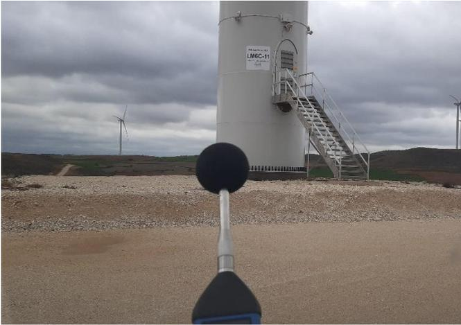
Fig. 1 Medición acústica en L6C.11. Fuente: Elaboración propia
