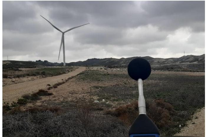
Fig.4 Medición acústica cerca de CA.09. Fuente: Elaboración propia
