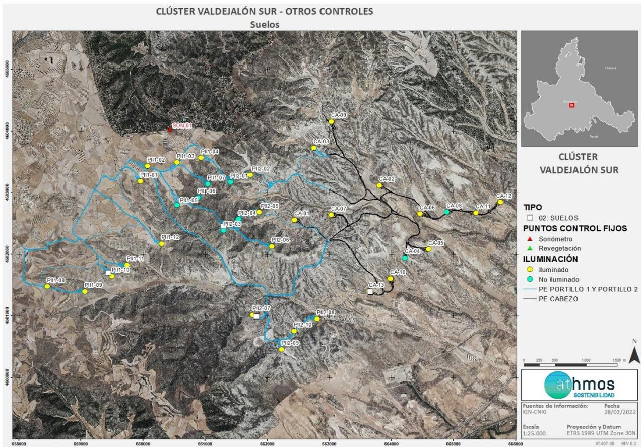
Fig. 1 Puntos detectados con suelos alterados o mal compactados en los parques eólicos del Clúster Valdejalón Sur. Fuente: Elaboración propia.
