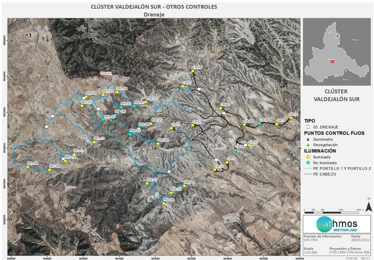
Fig. 1 Puntos detectados con drenajes deficientes o encharcamientos en los parques eólicos del Clúster Valdejalón Sur. Fuente: Elaboración propia.
