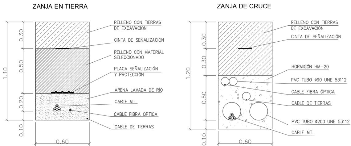
Ilustración 1. Sección zanja
