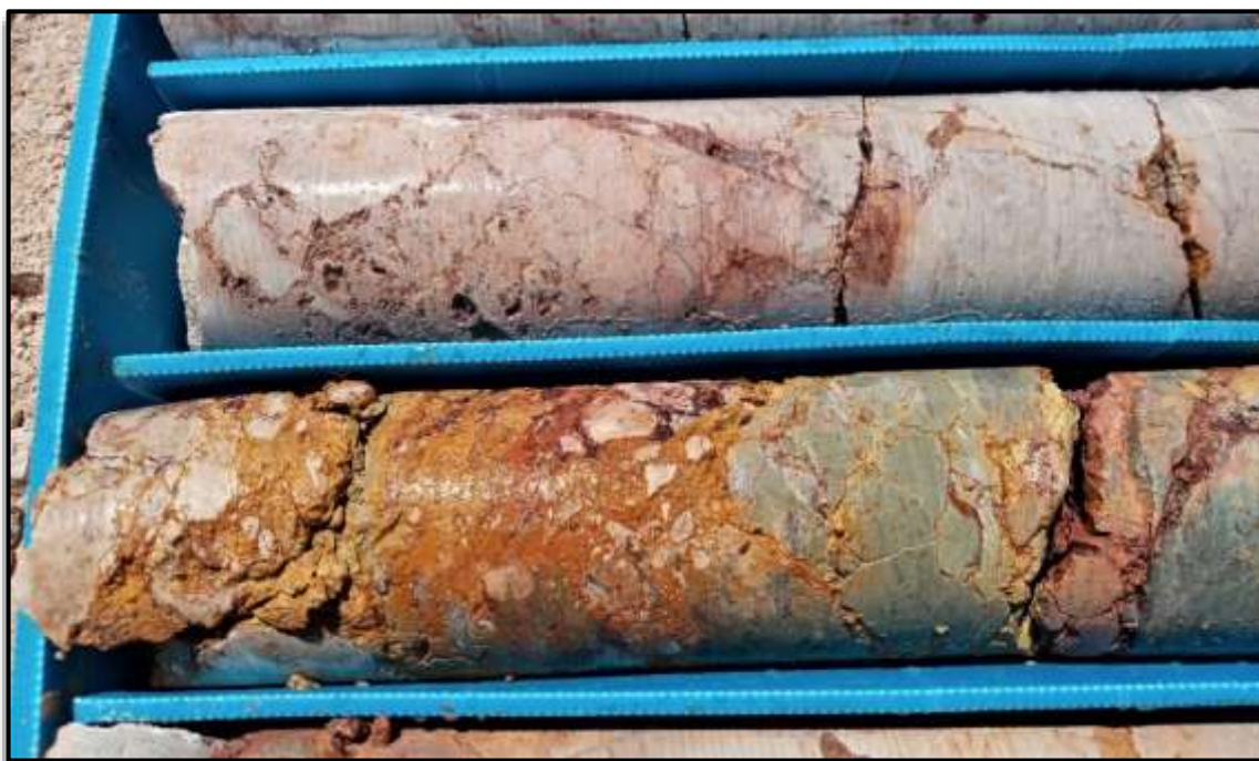
Fotografía n° 10. Calizas de la Formación Higuieruelas brechificadas. Fractura abierta por disolución, con rellenos arcillosos muy consolidados. Sondeo S 1 de mayo de 2022.
