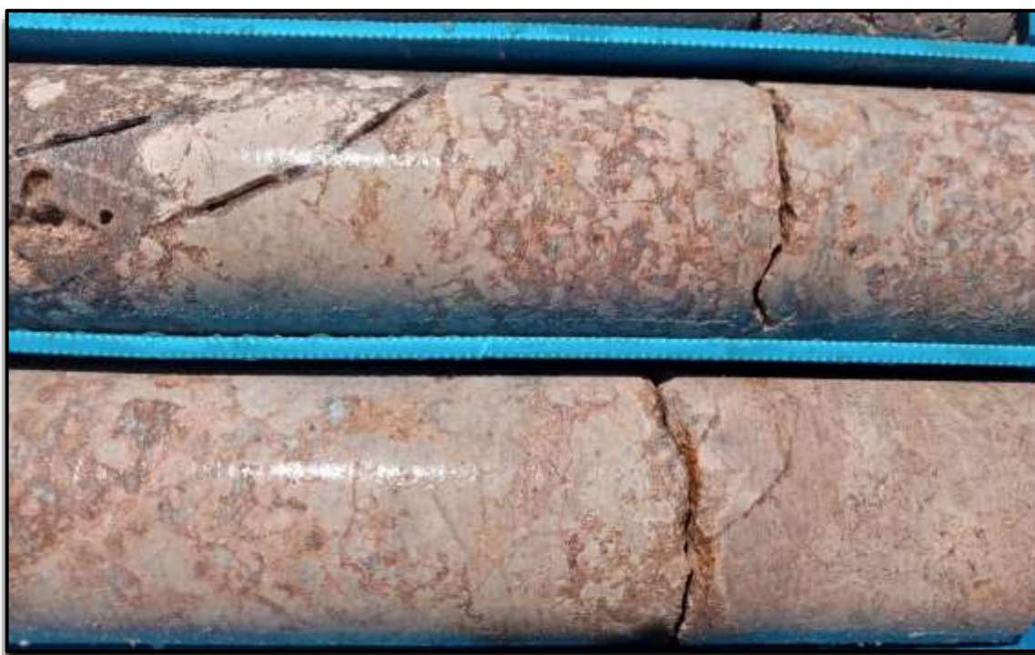
Fotografía n° 9. Calizas de la Formación Higuieruelas brechificadas, con parte del cemento constituido por minerales de hierro, posiblemente en un proceso de alteración diagenética debida a fluidos de origen hidrotermal. Sondeo S 1 de mayo de 2022.
