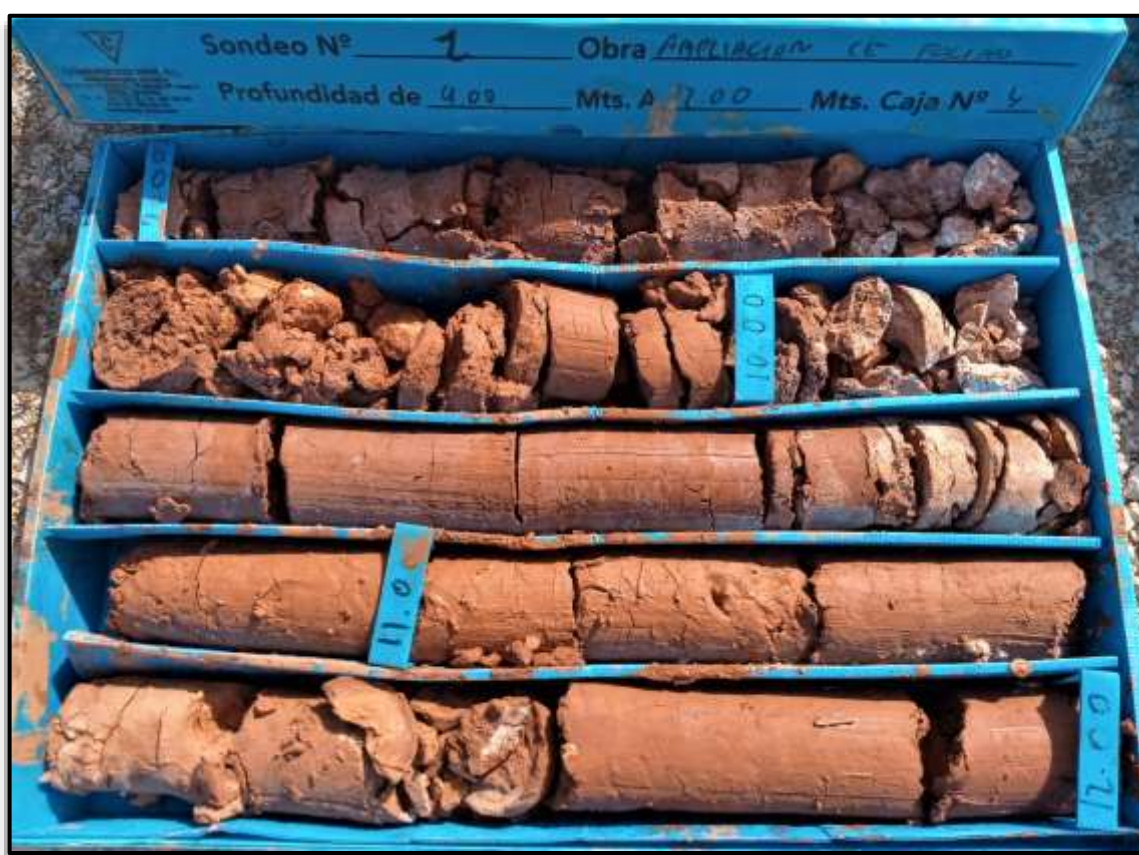
Fotografía nº 11. Lutitas rojas del Ageniense – Aragoniense perforadas en el sondeo S 2 de mayo de 2022. Alteran tramos masivos con tramos laminados y con ligeros cambios de color, debidos a cementos carbonáticos o presencia de yeso blanco.
