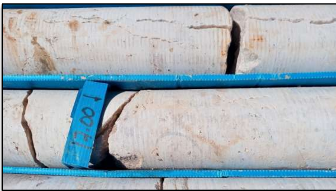
Fotografía nº 8. Calizas blancas de la formación Higuieruelas en los testigos del sondeo S 1 realizado en mayo de 2022.
