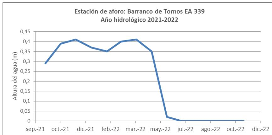
Gráfico 4. Altura de agua en la estación de aforo: barranco de Tornos. Año hidrológico 2021-2022.
