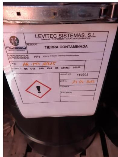
Fig. 3 Modelo de etiqueta en bidones de residuos peligrosos.
