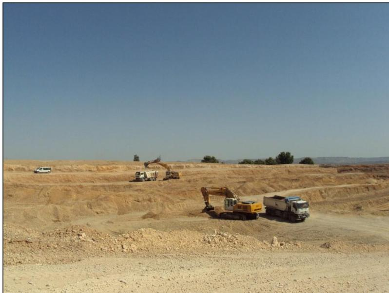
**Fotografía 1.-** Vista de la operación. Se observa lo indicado en la memoria. Bancos de operación de 3,5 metros para llegar a los bancos finales de 27 metros, con bermas de anchura mínima de 6 metros.
