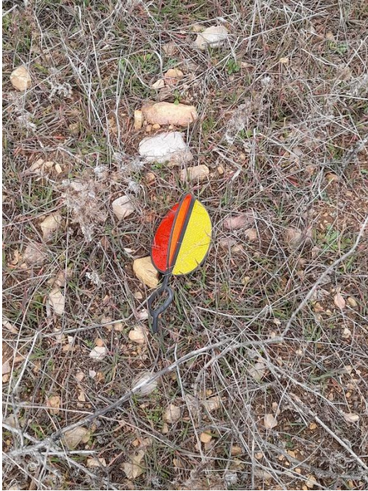
Fig 1 y 2. Baliza salvapájaros (izqda.) caída y cartel del vano (dcha.) 23 en el suelo.
