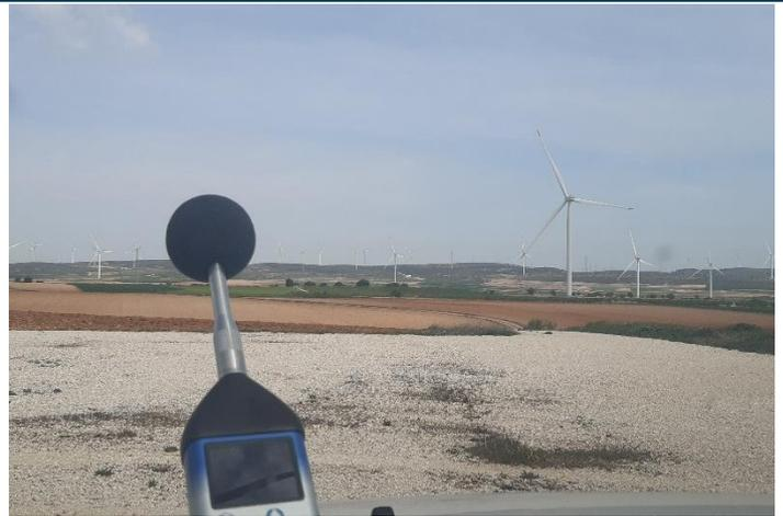
Fig.1 Medición acústica en LM5.04. Fuente: Elaboración propia
