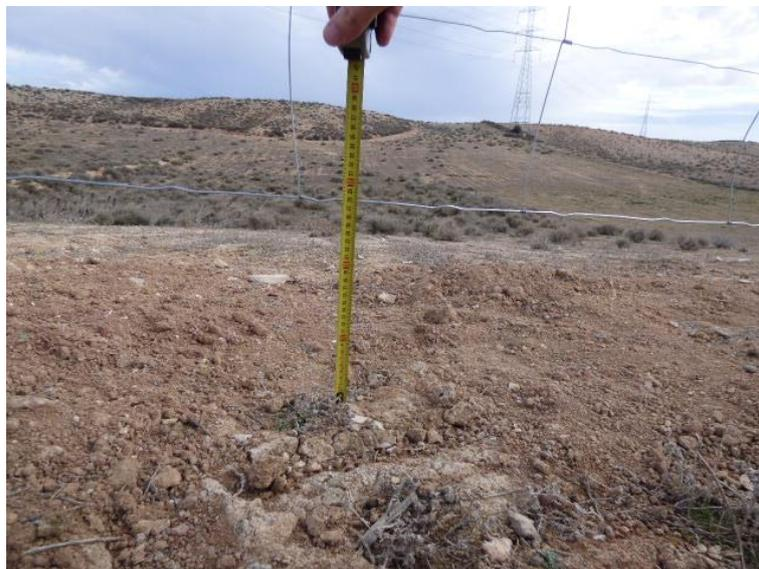
Figura 30. Altura libre del vallado (28 cm) superior a la indicada en la DIA (20 cm)
