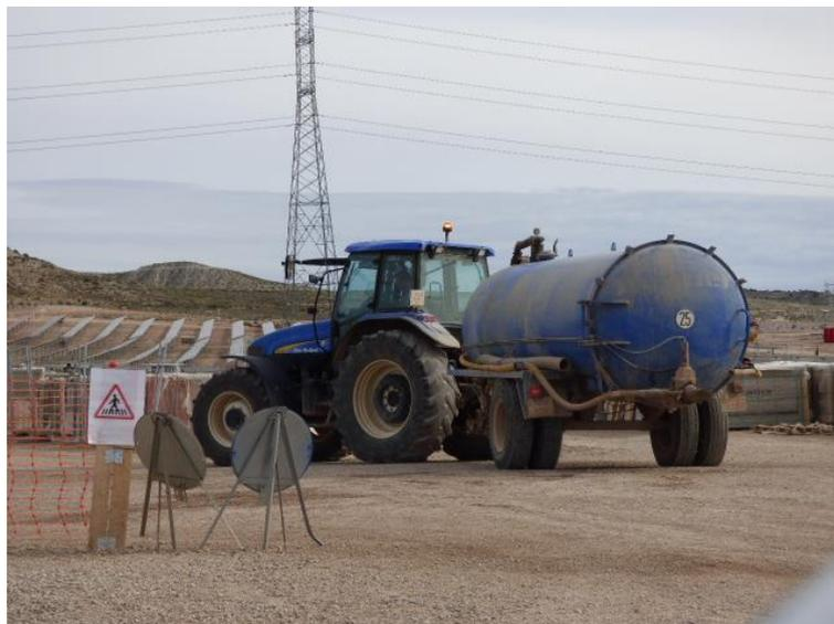
Figura 16. Cuba de agua tirada por tractor presente en la obra que permitiría apagar un conato de incendio en la obra
