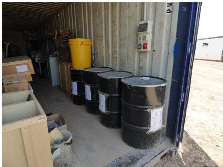
Figura 47. Depósitos homologados para el almacenamiento de residuos peligrosos
