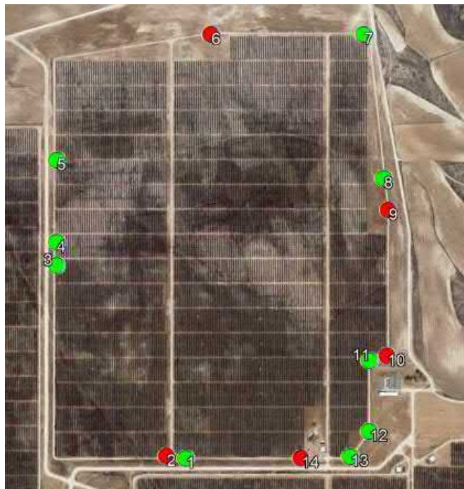
Figura 1: Mapa con la ubicación de las torres de vigilancia con cableado expuesto junto con los códigos adjudicados para su identificación (georreferenciado por el técnico de medio ambiente). Torretas con cableado expuesto (círculos rojos), torretas con cableado no expuesto (círculos verdes).
