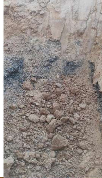
Fot 1 y 2. Detalle de los restos de alquitran de asfalto por debajo de los aportes realizados en los sectores B1 y B2 en PSFV Pitarco B
