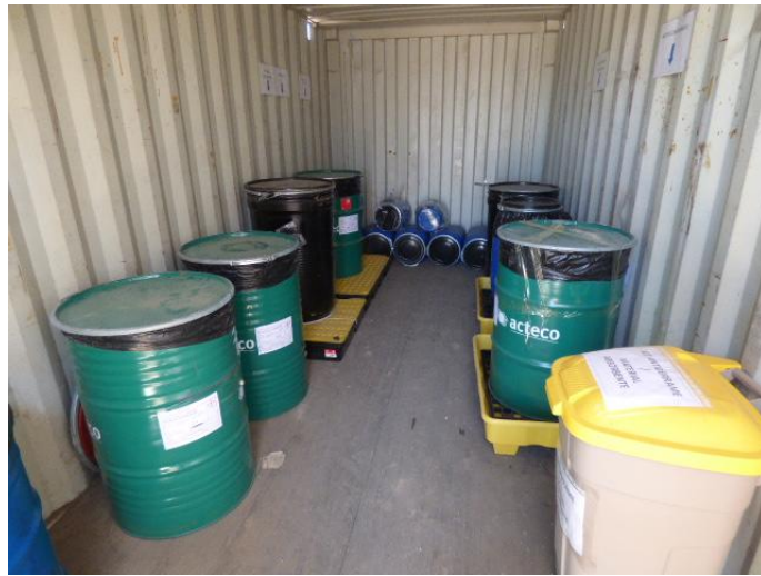
Imagen 28: Depósitos homologados e identificados conforme a la normativa vigente para el almacenamiento temporal de residuos peligrosos
