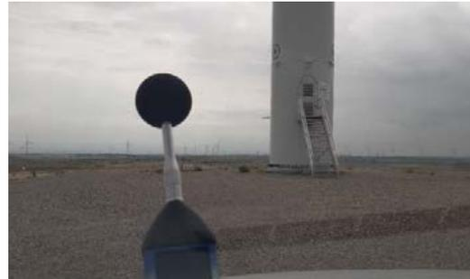
Fig.8 Medición sonómetro en VGI.11. Aerogenerador funcionando. Viento suave. Fuente: Elaboración propia
