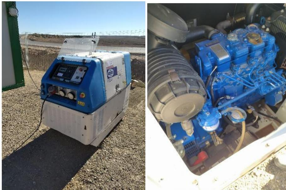
Grupo electrógeno con bandeja antiderrame interior integrada.
