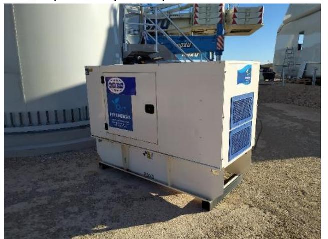
En caso de que los equipos electrógenos no lleven bandeja integrada, deberán de colocarse sobre lona o bandeja impermeable.
