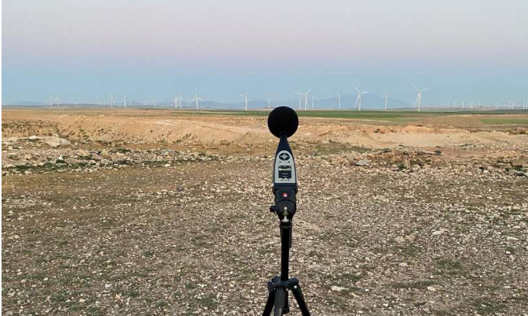
Foto nº1. Medición de ruido diurno en el punto de medición RPE-03, con PE Pedrola al fondo de la imagen.
