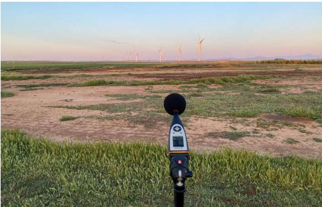
**Foto nº2.** Medición de ruido diurno en el punto de medición RPE-04, con PE Pedrola al fondo de la imagen.
