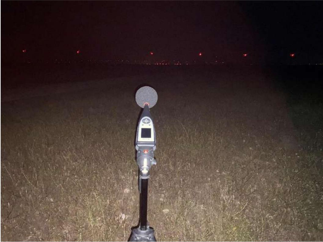
**Foto nº5.** Medición de ruido nocturno en el punto de medición RPE-05, con el PE Pedrola al fondo de la imagen.
