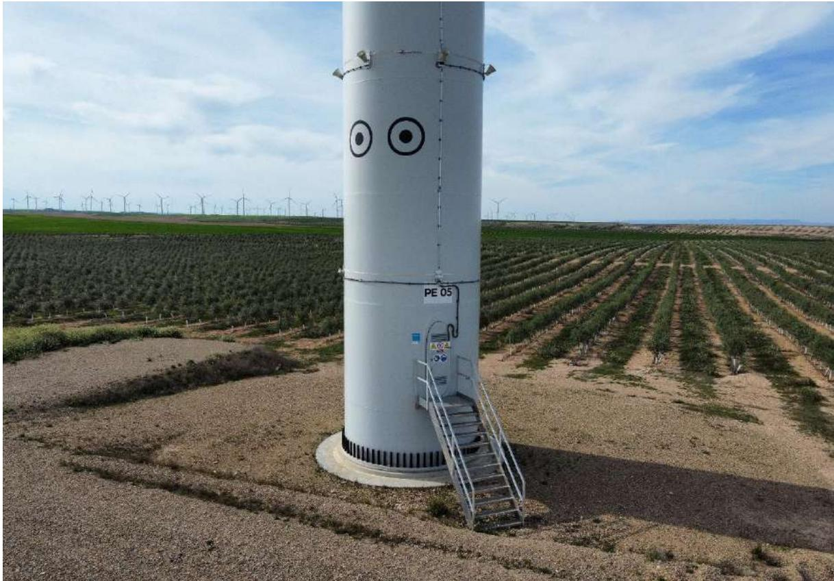
**Foto n°8.:** Dispositivo DTBird, y pintado “ojos de búho” en PE-05.
