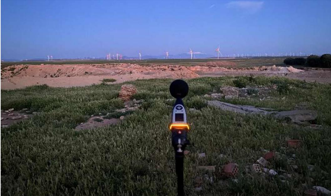
**Foto nº1.** Medición de ruido en el punto de medición RPE-03.
