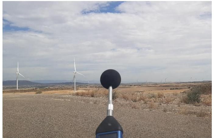
Fig. 4 Medición acústica en ML1.07. Fuente: Elaboración propia
