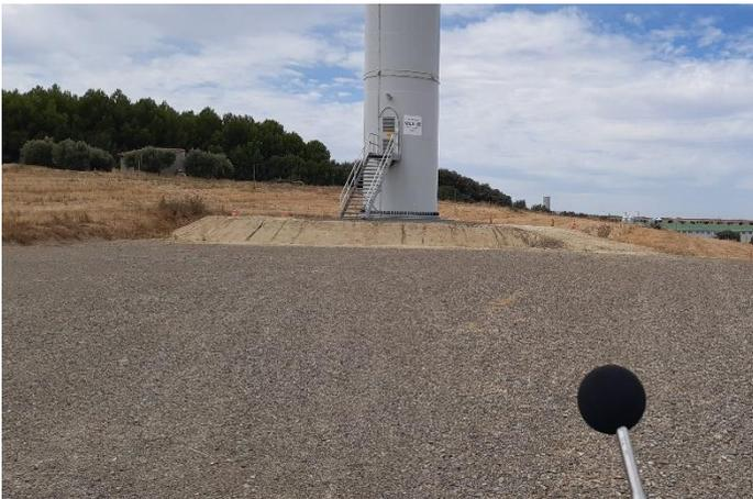
Fig. 3 Medición acústica cerca de ML1.03. Fuente: Elaboración propia
